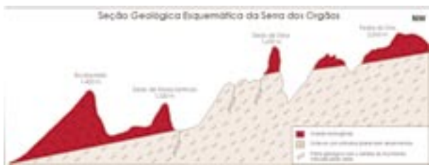
Figura 8: Seção geológica esquemática da Serra dos Órgãos. Extraído de DRM, 2005.
