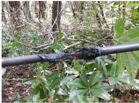
**Figura 64:** Cabo de fibra ótica da Embratel, danificado pelo fogo provocado pela rede elétrica, após queda de árvore. Data: julho de 2013.
