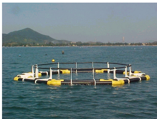
Fig.03: Tanque-rede utilizado para manutenção dos peixes em ambiente marinho e esquema ao lado demonstrando as dimensões da rede utilizada com volume equivalente a 78,5 m 3 .
