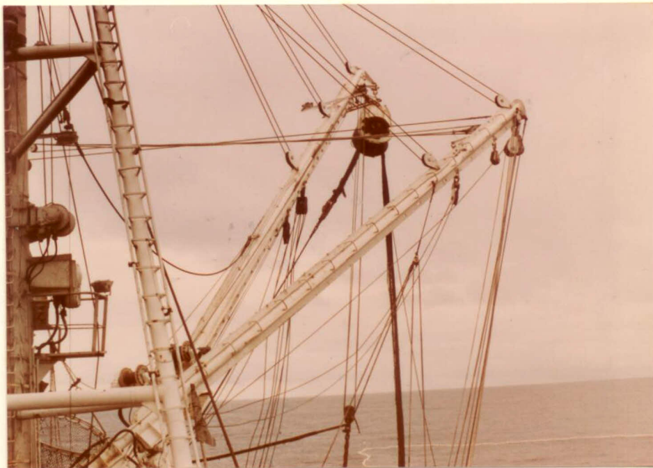
Início da passagem da rede pelo "POWER BLOCK"
