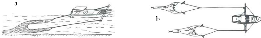
Figura 3 – Desenho esquemático de redes-de-arrasto utilizadas na pesca de camarão no Nordeste brasileiro: (a) rede-de-arrasto simples (uma rede) e (b) rede-de-arrasto duplo (duas redes).
