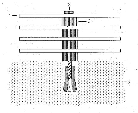
FIGURA 1. Representação esquemática de um grupo de placas de assentamento utilizados no experimento mostrando 1) placa de assentamento (azulejo), 2) parafuso inoxidável, 3) Espaçadores de PVC (20 mm), 4) bucha de nylon e 5) substrato recifal.
